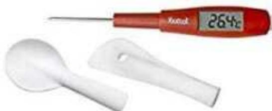
Spatule thermomètre de la marque Tellier pour mesurer la température de vos produits en °C ou °F avec une précision de plus ou moins 0,1 °C ou 0,1 °F. Fonctionne avec une pile LR44. Sa plage de températures est comprise entre -50°C et 300°C (-58°F et 572°F) et elle est compatible avec l'induction. Ses embouts spatule et cuillère sont amovibles.
