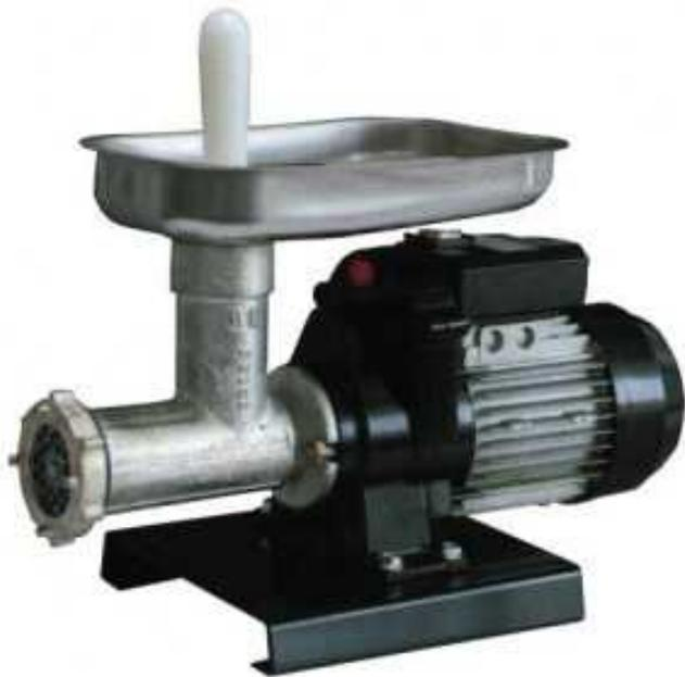
Hachoir à viande électrique Reber n° 12, 500 Watts, capacité de production de 60 à 100 kg/heure.
