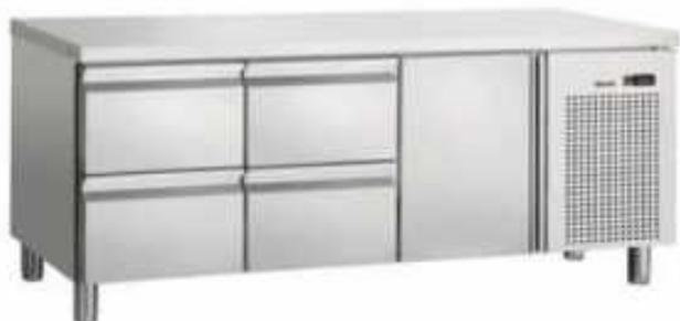
Table Réfrigérée ventilée en acier inoxydable ayant une plage de températures comprise entre 0°C et +10°C. Elle est équipée de 4 tiroirs GN 1/1 et d'un rangement avec étagère et porte battante. Le réglage de la température est électronique et à incréments de 0,1°C. Gaz R600a.
