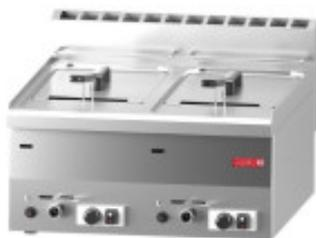
Cette **Friteuse Gaz 2 x 8L** est équipée d'un allumage piézo, d'une **soupape de sécurité thermostatique** et d'un **coupe-circuit thermique**. La température requise est atteinte rapidement grâce à deux tubes chauffants par cuve. Elle est fournie avec 2 paniers pouvant contenir 900g de frites chacun. Chaque cuve peut cuire jusqu'à 13 kg de frites par heure.
