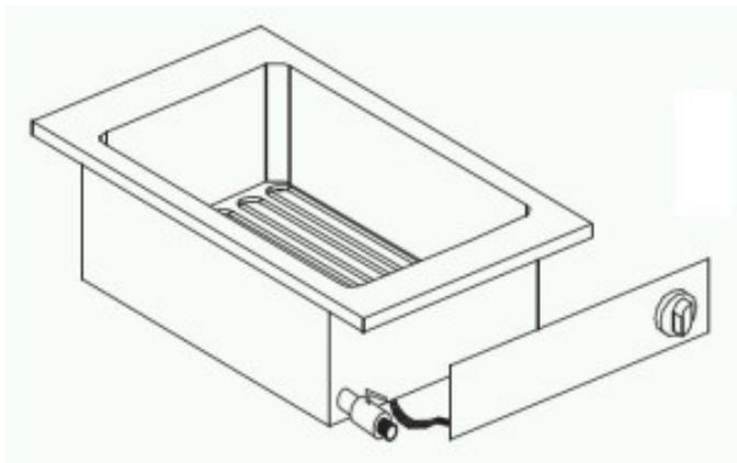
Friteuse électrique encastrable Drop-In de 10 L, idéale pour les professionnels de la restauration ou collectivité. Alimentation 400V, puissance de 5500W, production horaire de 10kg. Équipée d'une vanne de vidange, cette friteuse permet de préparer efficacement une grande quantité de frites croustillantes en un temps record.
