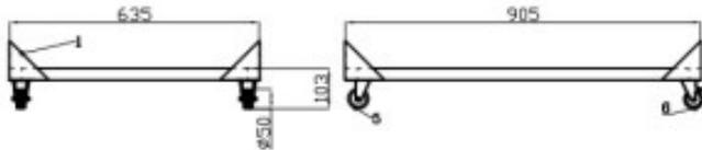
Ce support pour Saladette à 2 portes est conçu pour offrir une stabilité maximale à votre équipement de cuisine professionnel. Sa structure robuste avec une hauteur de 103mm, une longueur de 905mm et une profondeur de 638mm est idéale pour accueillir efficacement votre matériel. Il ne dispose pas de fonction de réfrigération mais constitue un accessoire essentiel pour organiser et faciliter la préparation des salades et des ingrédients dans les cuisines professionnelles.
